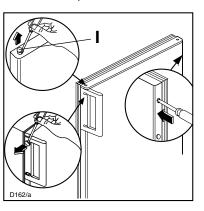
Darauf achten, dass alle Distanzscheiben und Unterlagen wieder an gleicher Stelle eingesetzt sind.
