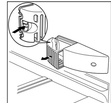
Die hintere Arretierung gegen das Gehäuse drücken bis die transparente Abdeckung ausrastet.
