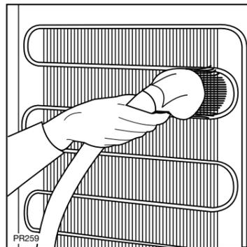
Halten Sie den Verflüssiger mit einem Staubsauger oder einer Bürste sauber.
