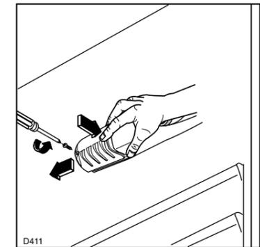
Befestigungsschraube der Lampenabdeckung entfernen.
