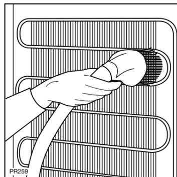
Den Verflüssiger mit einem Staubsauger oder einer Bürste sauber halten.
