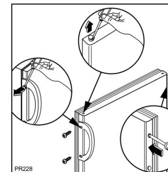
**Darauf achten, dass alle Distanzscheiben und Unterlagen wieder an gleicher Stelle eingesetzt sind.**
