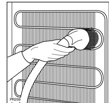
Verflüssiger mit einem Staubsauger oder einer Bürste sauber halten.
