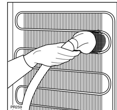
Den Verflüssiger mit einem Staubsauger oder einer Bürste sauber halten.
