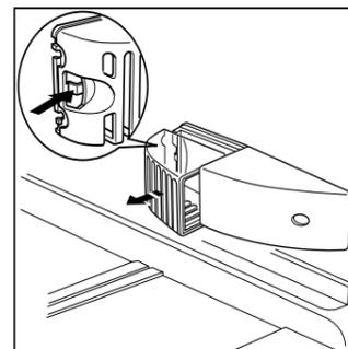
Die hintere Arretierung gegen das Gehäuse drücken bis die transparente Abdeckung austrastet.
