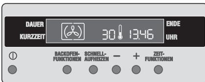
3. Zu jeder gewählten Betriebsart erscheint ein Temperaturvorschlag im Display (das Grad-Zeichen „°“ blinkt). Gleich anschließend kann durch Drücken der **+** - oder **-** -Taste die vorgeschlagene Temperatur in 5-Grad-Schritten geändert werden.
