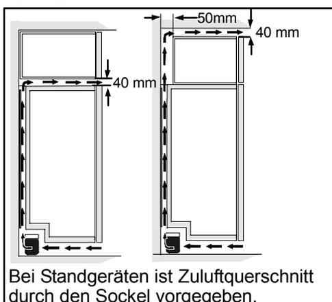
Bei Standgeräten ist Zuluftquerschnitt durch den Sockel vorgegeben.
