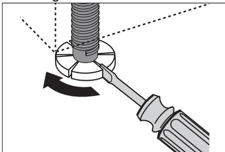
Die beiden hinteren Füße lassen sich mit einem Schraubenzieher von vorne regulieren, durch Drehen der Schrauben im Sockelbereich.
