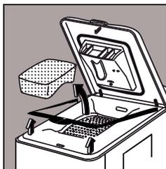
Öffnen Sie den Deckel des Geräts und entfernen sie die Transportsperre und die Plastikfolie. Schließen Sie den Deckel.
