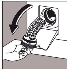
Flusensiebknäuel abschrauben und das Sieb herausziehen. Gründlich unter fließendem Wasser reinigen. Wieder einsetzen und im Uhrzeigersinn festschrauben
