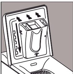
Schieben Sie die Waschmittelbehälter wieder in die Führung, bis diese einrastet.
