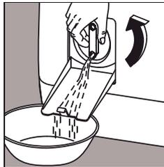
Stellen Sie hierbei einen Behälter unter. Flusensiebknäuel nach links entgegen dem Uhrzeigersinn in Mittelstellung drehen, damit das Restwasser ablaufen kann.
