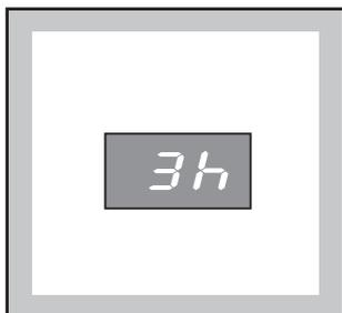
Nach Ablauf der vorgewählten Stunden bzw. Minuten beginnt der Trockner automatisch mit dem eingestellten Programm. Im Multidisplay wird die Laufzeit angezeigt. Der umgekehrte Zählvorgang wird alle 5 Minuten aktualisiert.
