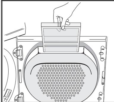
Die Reinigung des Flusensiebes in der Einfüllöffnung sollte, bevor Sie die Wäsche entnehmen, erfolgen.
