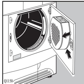
Durch Waschmittelreste in der Wäsche kann sich an den Flusensieben ein weißlicher Belag bilden. In diesem Falle müssen die Siebe, insbesondere das Sieb in der Einfüllöffnung, mit warmem Wasser und einer Bürste gereinigt werden.
