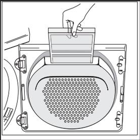
Die Reinigung des Flusensiebes in der Einfüllöffnung sollte erfolgen, bevor Sie die Wäsche entnehmen.
