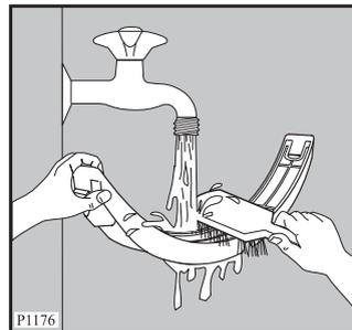
Das Sieb in der Einfüllöffnung kann auch herausgenommen werden (siehe Abb.). Beim Wiedereinsetzen kann der Zapfen nach rechts oder links zeigen.
