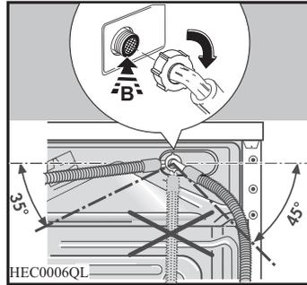
**2** Schließen Sie den Schlauch mit dem Winkelverbindungsstück an die Maschine an.
