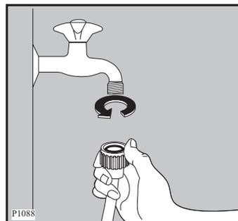
Bei geöffnetem Wasserhahn (unter vollem Leitungsdruck) die Anschlussstelle am Gerät und am Wasserhahn auf Dichtheit prüfen!
