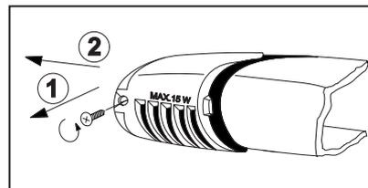
Abdeckung in Pfeilrichtung (1) anheben und in Pfeilrichtung (2) nach hinten schieben.
