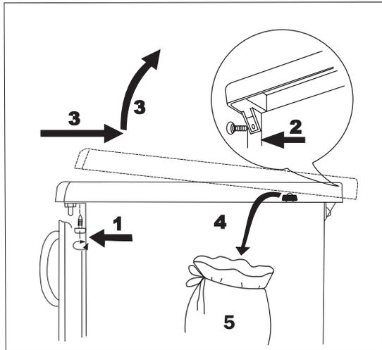
Mit einer geeigneten Schraube (Wahl je nach Beschaffenheit der Arbeitsplatte und des Abstandes Gerät zur Arbeitsplatte, nicht im Lieferumfang) das Gerät durch das obere Türscharnier unter der Arbeitsplatte befestigen. Hierbei bedarfsweise den Zwischenraum zwischen Türscharnier und Arbeitsplatte mit einer geeigneten Zwischenlage (Kunststoff oder Holz, nicht im Lieferumfang) ausgleichen. Hierdurch wird ein Verbiegen des Türscharniers und mögliche Funktionsstörungen der Tür verhindert.
