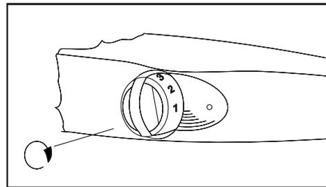
Zeigt die Markierung des Temperaturreglers auf "0", so ist das Gerät ausgeschaltet. Je weiter der Temperaturregler im Uhrzeigersinn gedreht wird, desto kälter sind die Temperaturen im Gerät. Bei normaler Umgebungstemperatur den Temperaturregler zunächst auf eine mittlere Position stellen. Kältere Temperaturen (siehe Energiespartipps) bedeuten unnötigen Stromverbrauch.
