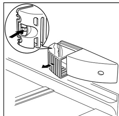
Die hintere Arretierung gegen das Gehäuse drücken bis die transparente Abdeckung austristet.
