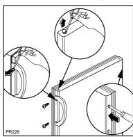
Gerät in Position bringen, ausrichten und ans Stromnetz anschließen.
