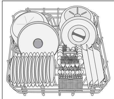
**!** Teile mit tiefem Boden möglichst schräg stellen, sodass das Wasser ablaufen kann.
