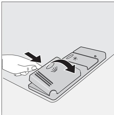
2. Reinigungsmittel in den Behälter für Reinigungsmittel (1) füllen. Als Dosierhilfe dienen die Markierungslinien: „20“/„30“ entspricht ca. 20/30 ml Reiniger.
