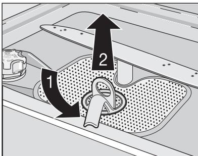
4. Grobsieb (A) an der Grifföse fassen und aus dem Mikrofilter (B) herausziehen.
