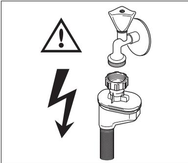
**!** Stromschlaggefahr: Im doppelwandigen Zulaufschlauch befindet sich die elektrische Leitung für das Sicherheitsventil. Weder Zulaufschlauch noch Sicherheitsventil unter Wasser tauchen.
