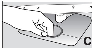
8. Grobsieb in den Mikrofilter einsetzen und zusammenstecken.
