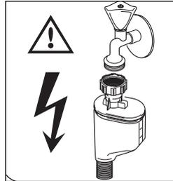
Im doppelwandigen Zulaufschlauch befindet sich die elektrische Leitung für das Sicherheitsventil. Weder Zulaufschlauch noch Sicherheitsventil unter Wasser tauchen.
