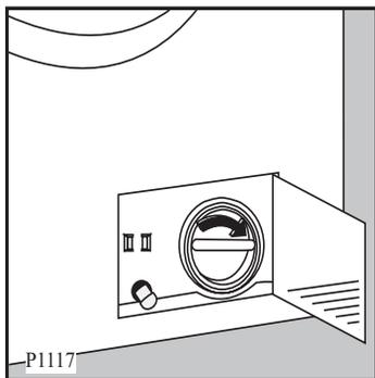
7. Die Grobkörperperle einsetzen und den Deckel im Uhrzeigersinn wieder fest verschrauben.
