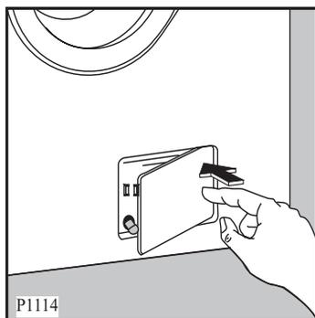
3. Notentleerungsschlauch aus seinem Sitz herausnehmen, Auffanggefäß unterstellen und Verschlussstopfen des Schlauchs herausziehen.
