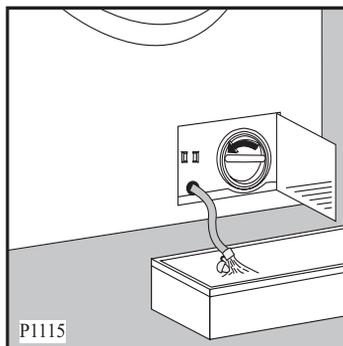
4. Wenn das Wasser vollständig abgelaufen ist, den Deckel der Ablaufpumpe entgegen dem Uhrzeigersinn abschrauben und herausziehen.
