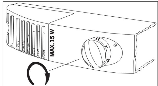
Zeigt die Markierung des Temperaturreglers auf "0", so ist das Gerät ausgeschaltet. Je weiter der Temperaturregler im Uhrzeigersinn gedreht wird, desto kälter sind die Temperaturen im Gerät. Bei normaler Umgebungstemperatur den Temperaturregler zunächst auf eine mittlere Position stellen. Kältere Temperaturen (siehe Energiespartipps) bedeuten unnötigen Stromverbrauch.
