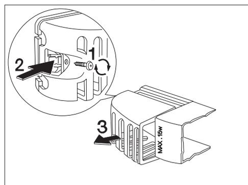
Glühlampe ersetzen- max. 15 Watt, 220-240 V, Fassung E14.
