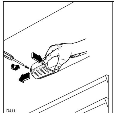
Befestigungsschraube der Lampenabdeckung entfernen.
