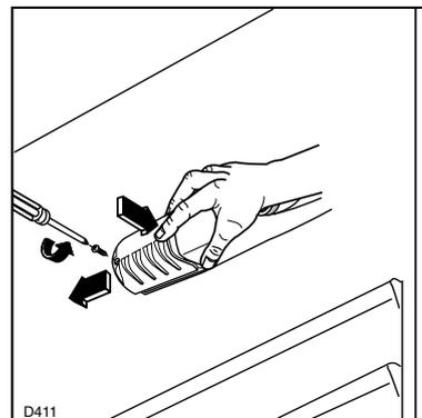
Befestigungsschraube der Lampenabdeckung entfernen.
