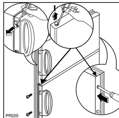
Eine Justierung der Türen ist über das mittlere Scharnier (H) möglich.
