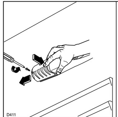
Befestigungsschraube der Lampenabdeckung entfernen.
