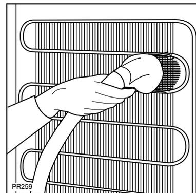
Verflüssiger mit einem Staubsauger oder einer Bürste sauber halten.
