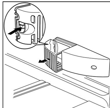
Die hintere Arretierung gegen das Gehäuse drücken bis die transparente Abdeckung ausrastet.
