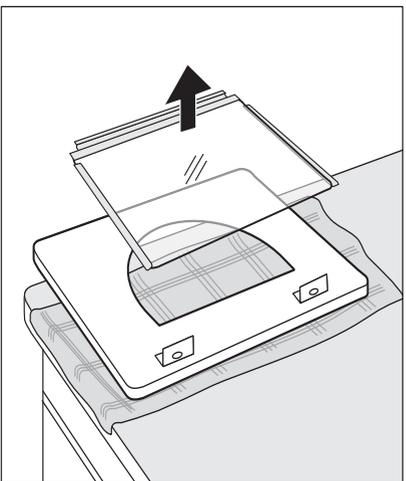
Ein Küchentuch unterlegen und die Backofentür mit der Außenseite auf eine waagerechte Fläche auflegen. Tür möglichst nicht auf dem Griff ablegen.
