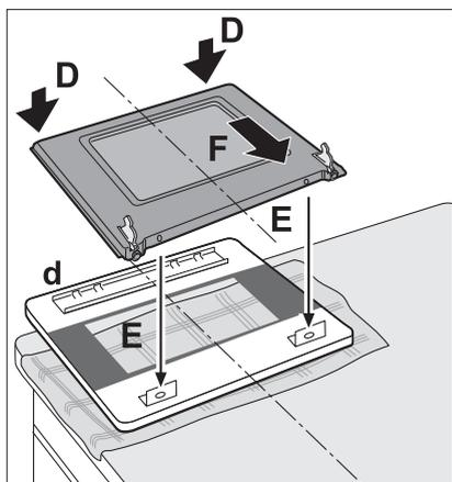
Ein Küchentuch unterlegen und die Backofentür mit der Außenseite auf eine waagerechte Fläche auflegen. Tür möglichst nicht auf dem Griff ablegen.
