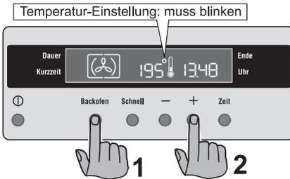
3. Zu jeder gewählten Betriebsart erscheint ein Temperaturvorschlag im Display (das Grad-Zeichen „°“ blinkt). Gleich anschließend kann durch Drücken der **+** - oder **-**-Taste die vorgeschlagene Temperatur in 5-Grad-Schritten geändert werden.
