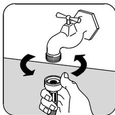
Bei geöffnetem Wasserhahn (unter vollem Leitungsdruck) die Anschlussstelle am Gerät und am Wasserhahn auf Dichtheit prüfen! Zur Vermeidung von Wasserschäden muss der Wasserhahn nach dem Waschen abgestellt werden.
