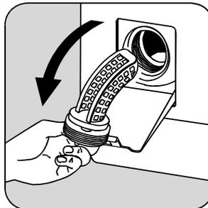
4. Flusensieb wieder einsetzen und fest verschrauben. Klappe schließen.
