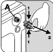
Achten Sie darauf, dass die Dichtung **A** nicht verrutscht oder entfernt wird.
