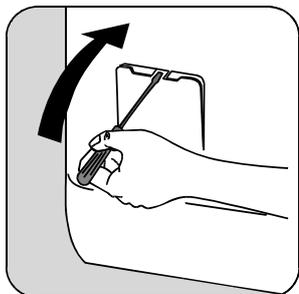
2. Flusensieb-Knebel nach links entgegen dem Uhrzeigersinn in vertikale Position drehen und Restwasser ablaufen lassen.
