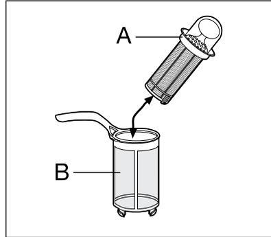
5. Alle Siebe unter fließendem Wasser gründlich reinigen.
