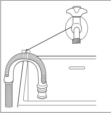
Schnur durch das Loch des Schlauchkrümmers ziehen und an der Wand oder am Wasserhahn befestigen.
