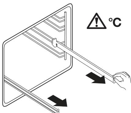
2. Punetă raftul pe suporturile raftului telescopic, apoi împingeți-le cu grijă în interiorul cuptorului.
