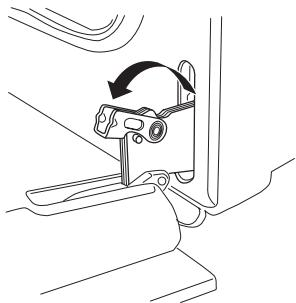
3. Închideți ușa cuporului până la prima poziție de deschidere (aprox. 45°). Trageți apoi ușa înainte și scoateți-o din locașul său.
