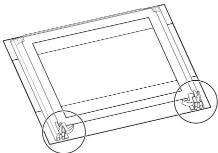
5. A zárrendszer kioldásával emelje ki a belső üveglapot.
