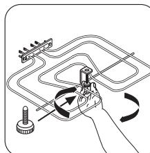
① Desfaceți șurubul care fixează elementul grătar. Când efectuați această operație pentru prima oară, se recomandă să folosiți o șurubelnită.
