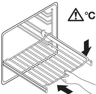
**Avertizare** Nu încercați să închideți ușa cuptorului dacă suporturile raftului telescopic nu sunt complet în interiorul cuptorului. Acest lucru poate deteriora smâlțul și sticla ușii.
