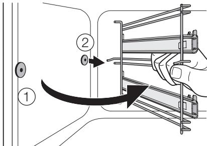
Curătați ghidajele raftului cu apă caldă cu săpun. Ștergeți cu o lavetă moale. Nu utilizați produse abrazive, care le-ar putea deteriora. După ce ați terminat de curătat puneți ghidajele raftului și panoul catalitic la loc. Pentru a pune la loc ghidajele raftului și panourile catalitice, urmați procedura în ordine inversă.
