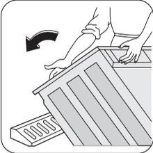
Legen Sie die Maschine nach Entfernen der Verpackung vorsichtig auf die Rückseite, um die Styroporplatte unter der Maschine zu entfernen.
