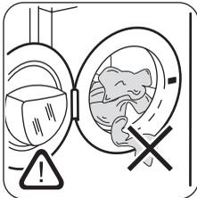
**! Warnung!** Achten Sie darauf, dass beim Schließen der Tür keine Textilien eingeklemmt werden.
