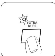
Wenn diese Taste gedrückt wird, leuchtet die entsprechende Kontrolllampe auf.
