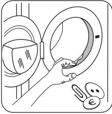
Kontrollieren Sie am Ende eines jeden Waschgangs die Türdichtung und entfernen Sie eventuelle Fremdkörper aus den Falten.
