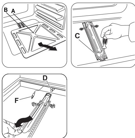
1. Pentru a avea acces la arzătorul (B) înălăturați podeaua interioară a cupotorului (A).
