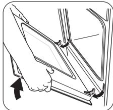
**3** Închideți ușa cuptorului până la prima poziție de deschidere (jumătate). Trageți apoi ușa înainte și scoateți-o din locașul său.
