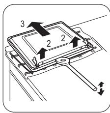
**5** Pentru deschiderea ușii interioare utilizați o spatulă din lemn, plastic sau material similar. Țineți ușa exterioară și împingeți ușa interioară în sus.
