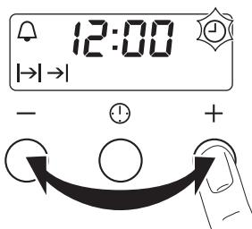
Na ongeveer vijf seconden stopt het knipperen en geeft de klok de ingestelde tijd van de dag weer.
