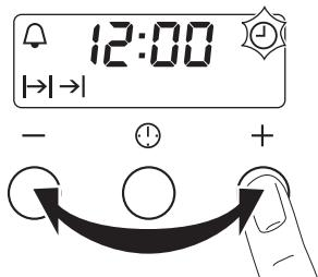
Nach etwa 5 Sekunden hört die Anzeige auf zu blinken und zeigt die eingestellte Uhrzeit an.
