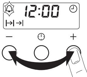
3. Drücken Sie + oder -, um die Zeit für die gewünschte Uhrfunktion einzustellen. Die von Ihnen eingestellte Uhrfunktion wird im Display angezeigt. Nach Ablauf der eingestellten Zeit blinkt die Anzeige, und es ertönt zwei Minuten lang ein Signalton.
