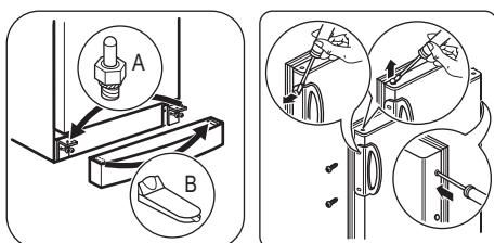
7. Desfaceți șurubul (A) și montați-l pe partea opusă.
