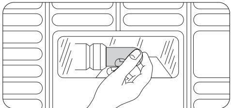
2. Ersetzen Sie die defekte Lampe durch eine Lampe mit der gleichen Leistung, die spe-
