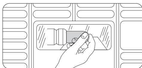
2. Substitua a lâmpada por uma com a mesma potência e especialmente concebida para aparelhos domésticos. (a potência máxima está indicada na cobertura da lâmpada).
