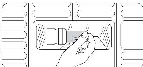
2. Lambayı aynı güç değerinde ve özellikle ev cihazları için tasarlanmış bir lambayla değiştirin (maksimum güç değeri lamba kapağında gösterilmiştir).
