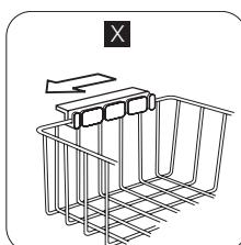
Sepetleri dondurucunun üst kenarına asın (X) veya dondurucunun içine yerleştirin (Y).
