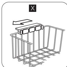
Hängen Sie die Körbe auf die Oberkante des Gefriergeräts (X) oder in das Innere des Geräts (Y).
