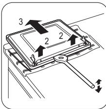
**5** Pentru deschiderea ușii interioare utilizați o spatulă din lemn, plastic sau material similar. Tineți ușa exterioară și împingeți ușa interioară în sus.
