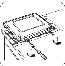
**4** Puneți ușa pe o suprafață stabilă, protejată de o lavetă moale. Cu o șurubelnită scoateți cele 2 șuruburi din partea de jos a ușii.
