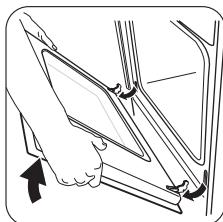
**3** Închideți ușa cuptorului până la prima poziție de deschidere (jumătate). Apoi trageți spre înainte și scoateți-o din locaș.
