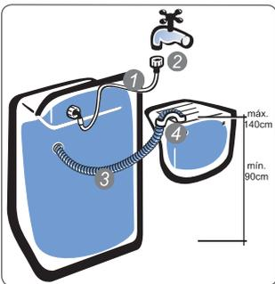
Obs.: A pressão de entrada de água deve estar entre 2,4 e 81 metros de coluna d'água (0,02 - 0,81 MPa). Caso a pressão da água de sua residência seja maior, use redutor de pressão.
