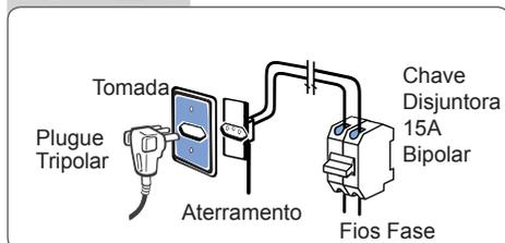
Para a Lavadora 220V (entre duas fases), utilize um disjuntor bipolar de 15A.
