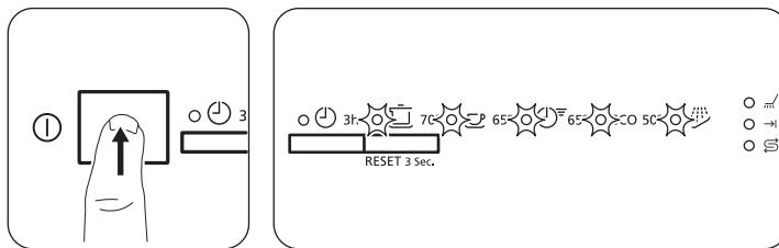
Das Gerät befindet sich im Programmwahlmodus, wenn alle Programmkontrolllampen leuchten.
