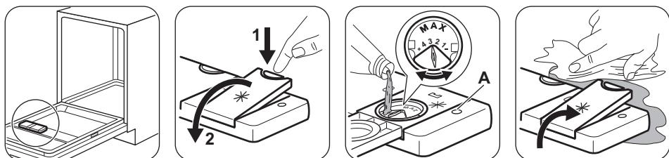
Klarspülmittel ermöglichen das Trocknen des Geschirrs ohne Streifen und Flecken. Es wird automatisch während der heißen Spülphasen abgegeben. Füllen Sie den Klarspülmittel-Dosierer, wenn das Schauglas (A) transparent ist.
