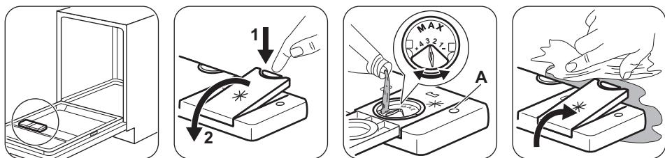
Le liquide de rinçage permet de sécher la vaisselle sans laisser de traînées ni de taches. Il est automatiquement libéré au cours de la phase de rinçage chaud. Remplissez le distributeur de liquide de rinçage lorsque l'indicateur (A) est vide.
