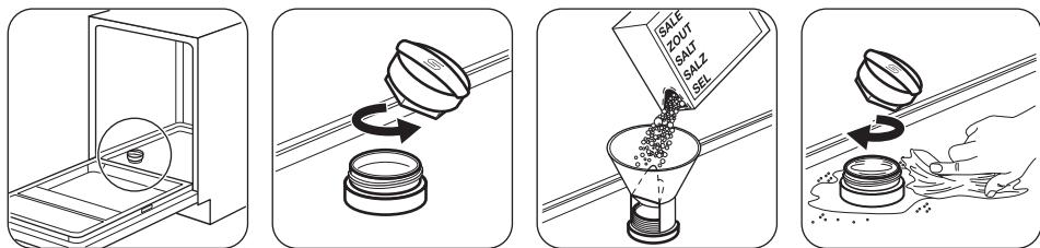
Avant la première utilisation, versez un litre d'eau dans le réservoir de sel régénérant.
