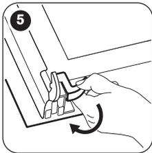
**5** Lösen Sie das Verriegelungssystem, um die innere Glasscheibe zu entfernen.
