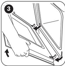
**3** Schließen Sie die Backofentür halb bis zur ersten Raststellung. Anschließend ziehen Sie sie nach vorn aus der Halterung heraus.
