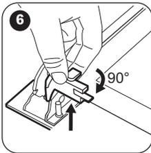
**6** Drehen Sie die beiden Befestigungselemente um 90 Grad und nehmen Sie sie aus der Halterung.
