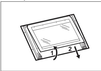
8. Reinig de glasplaat met een sopje. Droog de glasplaat voorzichtig af. Als u ze gereinigd hebt, monteer dan de glasplaat en de ovendeur. Voer bovenstaande stappen uit in de omgekeerde volgorde.
