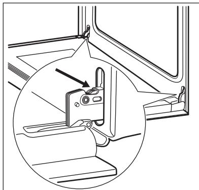
2. Heben Sie die Hebel der beiden Scharniere an, und klappen Sie sie nach vorn.
