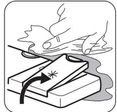
Klarspülmittel ermöglichen das Trocknen des Geschirrs ohne Streifen und Flecken. Es wird automatisch während der heißen Spülphasen abgegeben.
